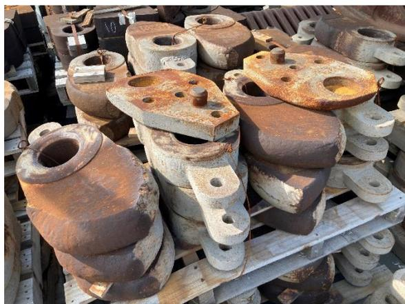
大型破碎機の刃：使用后
