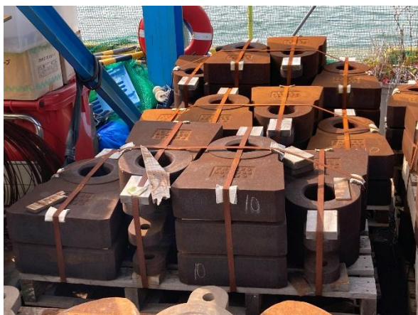
大型破碎機の刃：使用前
