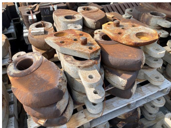
大型破碎機の刃：使用后
